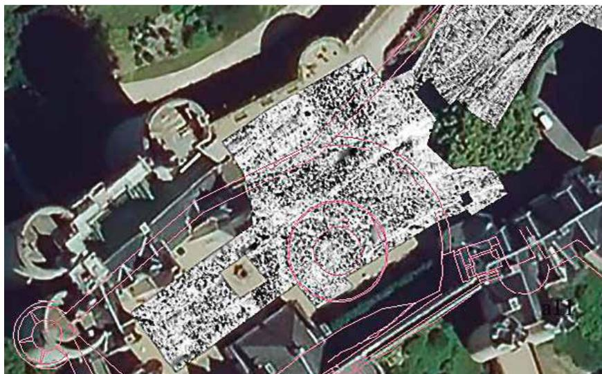
Fig. 12 – Montreuil-Bellay, château, extrait d'une analyse géoradar à une profondeur de 1,80 m, superposée à une vue aérienne Google Earth. On y a superposé (en rosé) la restitution de la tour maîtresse, et figuré l'emprise des douves reconnaissables par radar.
