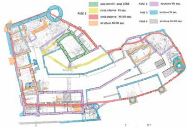
Fig. 5 - Quart, plan synoptique des phases constructives (G. Sartorio).
